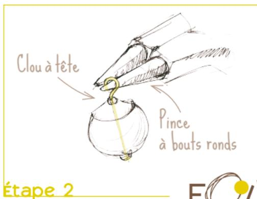
2. À l'aide d'une pince à bouts ronds, je forme une boucle en courbant l'extrémité du clou.
